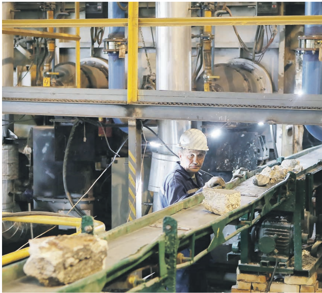
△ Со стенок печи снимают старую футеровку © ВАЛЕРИЙ ПОКУМЕЙКО
